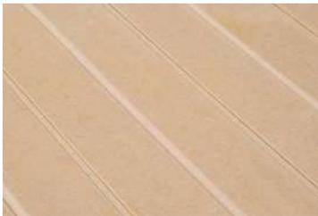
Las placas ETERBOARD LISTONES 7C están elaboradas con cemento, sílice, fibras de celulosa y aditivos, fraguadas en autoclave para ofrecer durabilidad y un acabado que simula listones de madera. Cumplen con la norma NTC 4373, que regula las propiedades físicas del fibrocemento de calidad.
