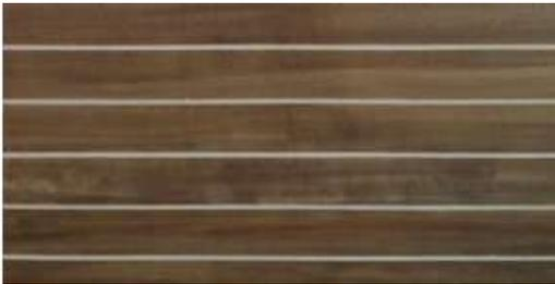
Las placas de fibrocemento Eterboard Tablilla Madera, compuestas de cemento, sílice, fibras de celulosa y aditivos, son curadas en autoclave y ofrecen un acabado que imita tablones de madera. Cumplen con la norma NTC 4373 para placas planas de fibrocemento de calidad.
