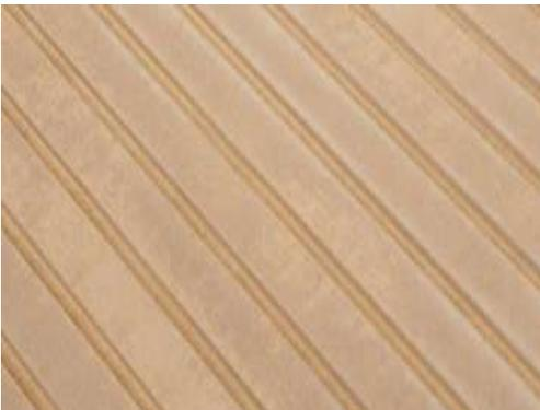
Las placas de fibrocemento Eterboard Listones imitan listones de madera, combinando estética con la resistencia y fácil instalación del fibrocemento. Están hechas con cemento, sílice, fibras de celulosa y aditivos, curadas en autoclave para mayor durabilidad. Cumplen con la norma NTC 4373, que garantiza su calidad.
