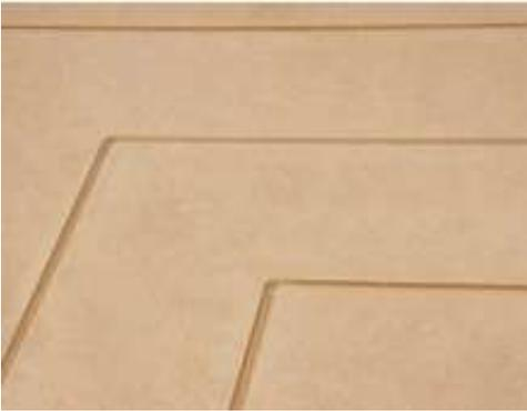
Las placas de fibrocemento ETERBOARD VECTOR, compuestas de cemento, sílice, fibras de celulosa y aditivos, son curadas en autoclave para asegurar durabilidad y un acabado de alta calidad. Su diseño decorativo en forma de 'V', con líneas precisas y simétricas, aporta dinamismo, fuerza visual y un toque moderno. Cumplen con la norma NTC 4373 para placas planas de fibrocemento de calidad.
