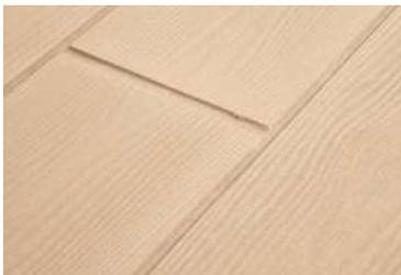
Las placas ETERBOARD TABLILLA E-CEDAR simulan listones de madera con textura de cedro. Están fabricadas con cemento, sílice, fibras de celulosa y aditivos, fraguadas en autoclave, y cumplen con la norma NTC 4373 para placas planas de fibrocemento de calidad.
