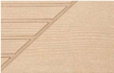
Las placas ETERBOARD LISTONES DIAGONAL presentan un diseño texturizado con listones lineales interrumpidos por una franja diagonal central que añade dinamismo visual. Están fabricadas con cemento, sílice, fibras de celulosa y aditivos, fraguadas en autoclave para garantizar durabilidad y un acabado estético. Cumplen con la norma NTC 4373, que regula la calidad de las placas planas de fibrocemento.
