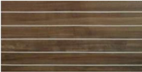
Las placas de fibrocemento Eterboard Tablilla E – Madera, hechas con cemento, sílice, fibras de celulosa y aditivos, son curadas en autoclave y simulan acabados tipo tablonces de madera. Cumplen con la norma NTC 4373 para placas planas de fibrocemento de calidad.
