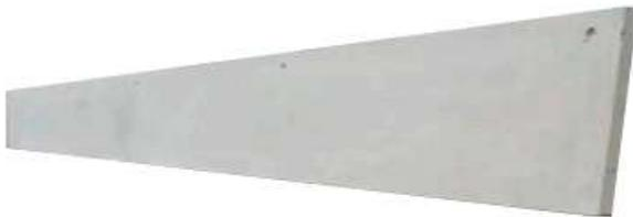
Las placas de fibrocemento Eterboard Tablilla Sencilla CR, hechas con cemento, sílice, fibras de celulosa y aditivos, son curadas en autoclave y ofrecen un estilo tipo Siding. Cumplen con la norma NTC 4373 para placas planas de fibrocemento de calidad.
