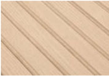
Las placas ETERBOARD LISTONES CEDAR simulan listones de madera de cedro, combinando un acabado estético con la resistencia y facilidad de instalación del fibrocemento. Están fabricadas con cemento, sílice, fibras de celulosa y aditivos, fraguadas en autoclave para garantizar durabilidad. Cumplen con la norma NTC 4373, que define los requisitos de calidad para placas planas de fibrocemento
