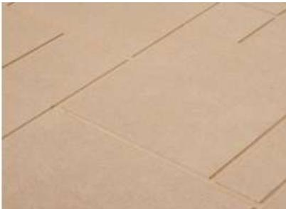
Las placas de fibrocemento Eterboard Pizarra, elaboradas con cemento, sílice, fibras de celulosa y aditivos, son curadas en autoclave y simulan acabados de piedra pizarra. Cumplen con la norma NTC 4373 para placas planas de fibrocemento de calidad.
